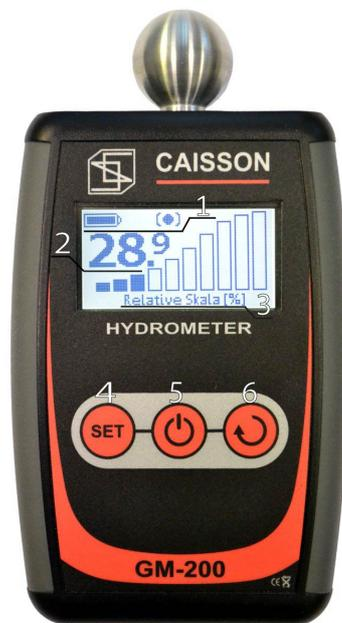
1 - Statusleiste; 2 - Messwert; 3 - Bezeichnung der ausgewählten Skala; 4 - 'SELECT MATERIAL'-Taste; 5 - 'ON'-Taste; 6 - 'SELECT DISPLAY'-Taste.
