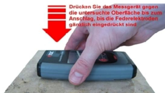
Aufgrund der Tendenz zur einer ungleichmäßigen Feuchtigkeitsverteilung im aushärtenden Beton empfiehlt es sich, mehrere Messungen an dicht aneinander liegenden Stellen vorzunehmen.
