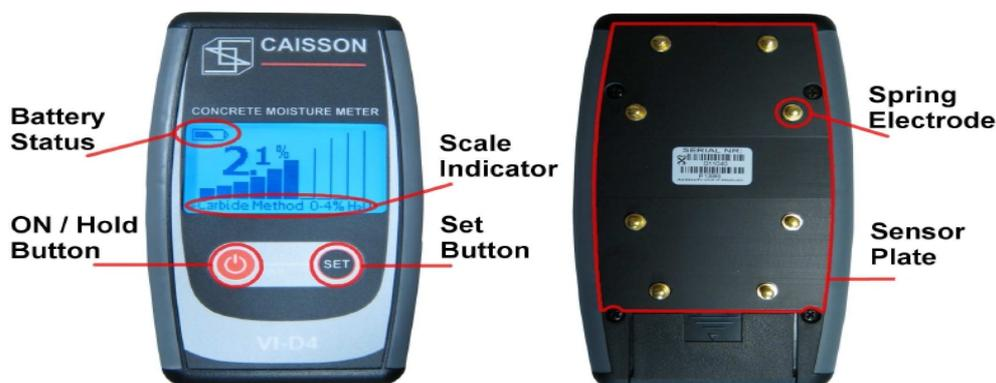
Das Feuchtigkeitsmessgerät durch die Betätigung der ON-/HOLD-Taste einschalten.
